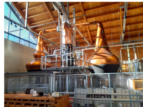
蒸溜釜。写真右がストレート・ヘッド型、左のひょうたん状がバルジ型
